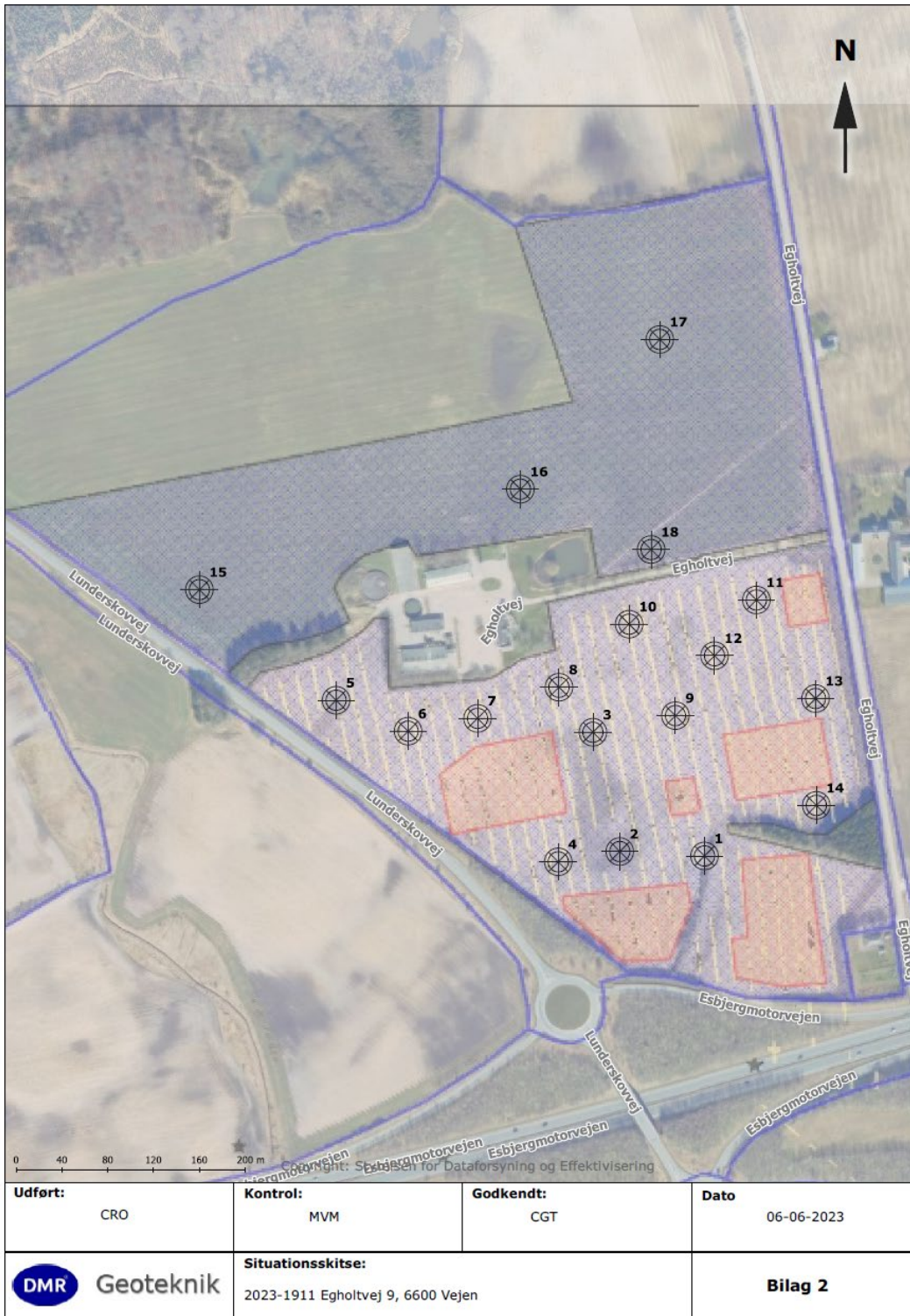
Figur 12-3: Kortbilag til geoteknisk undersøgelse med undersøgelsesboringer samt deres placering. De 18 boringer er markeret indenfor det skraverede område, med sorte cirkler med kryds i.
